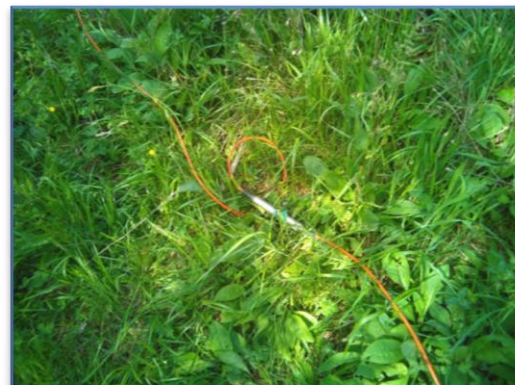
Elettrodo collegato ad un picchetto in ottone
