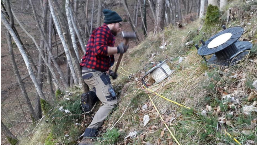
LINEA TSD10 - Sismica a rifrazione
