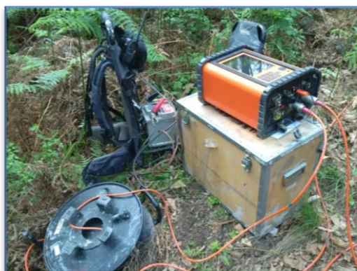
Georesistivometro multielettrodo ABEM Terrameter LS con elettrodi passivi.
