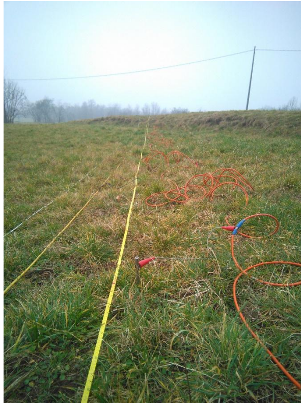
LINEA TSD1 - Tomografia elettrica
