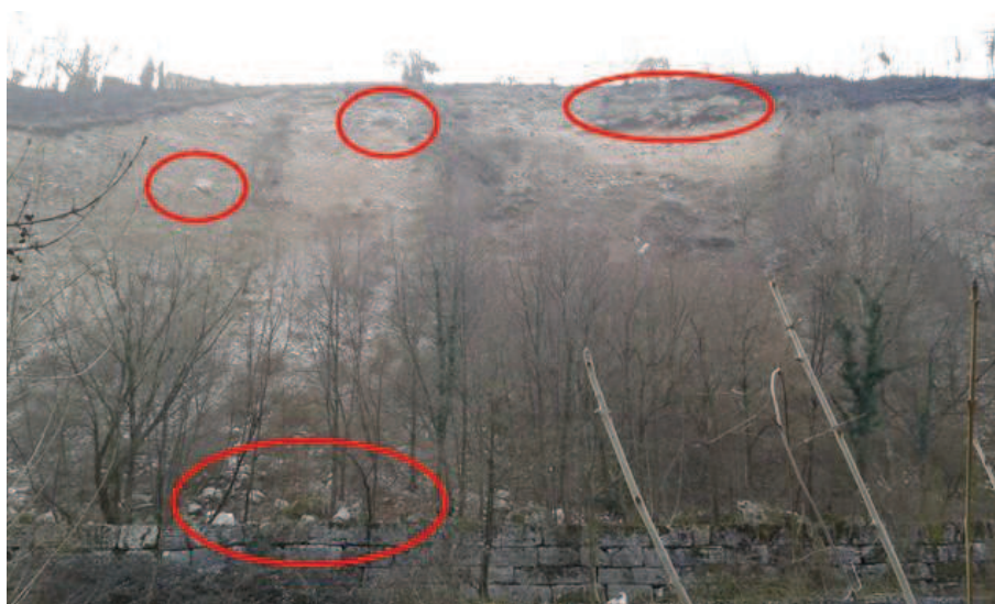
Figura 9.0.1 - La superficie di frana accanto al viadotto Piovene permette di osservare più chiaramente la natura del materiale inglobante frammenti ciottoli, massi e orizzonti superficiali ben cementati
