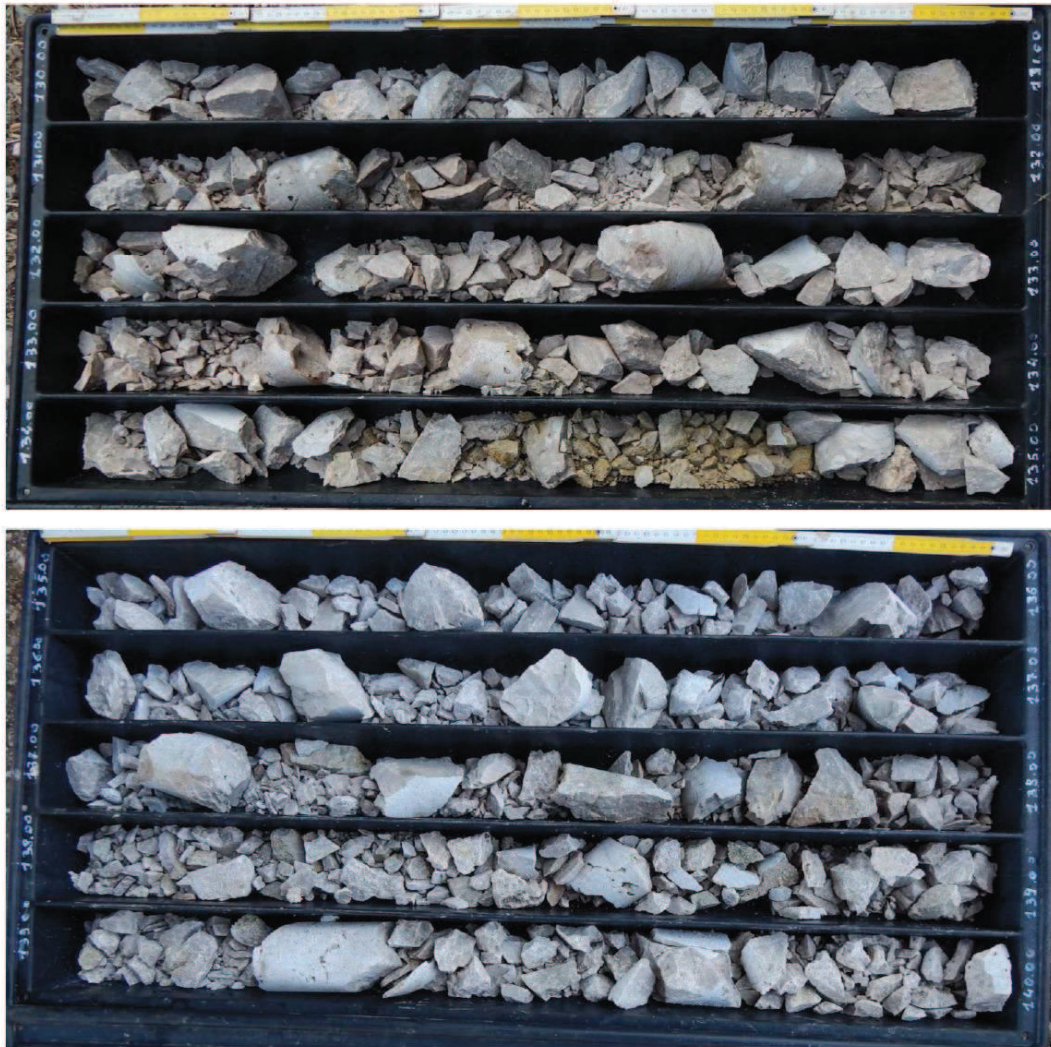
Figura 6.2.b – Foto carote estratte da carotaggio S14D, rappresentative delle condizioni prevalenti per la tipologia di ammasso 2
