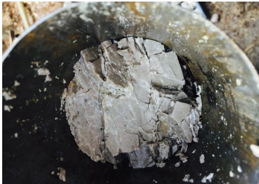
Figura 4.5.c Ammasso roccioso micro-fratturato ma recuperato integro all'interno del carotiere
