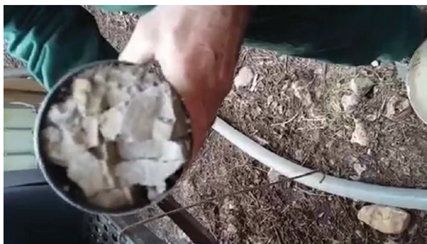
Figura 4.5.b Ammasso roccioso micro-fratturato ma recuperato integro all'interno del carotiere
