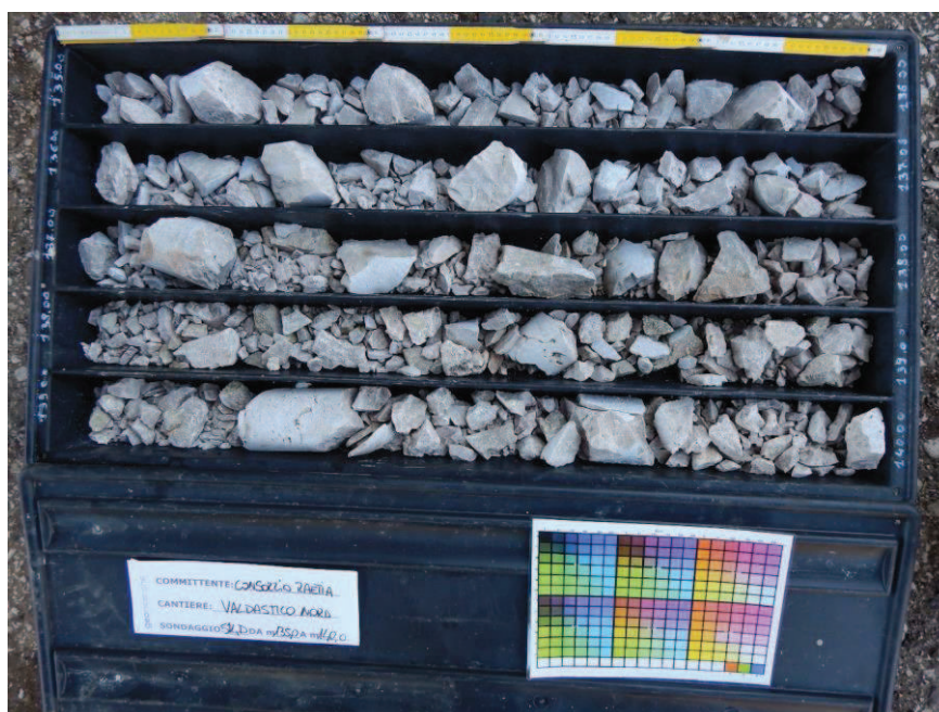
Figura 4.9 Cassette estratte nel tratto di profondità comprese tra 135 e 140m
