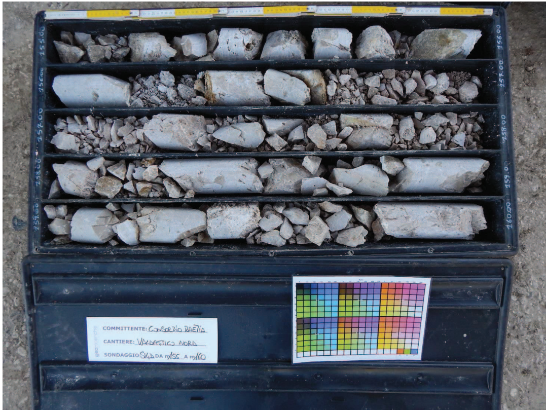
Figura 4.12 Cassette estratte nel tratto di profondità comprese tra 155 e 160m
