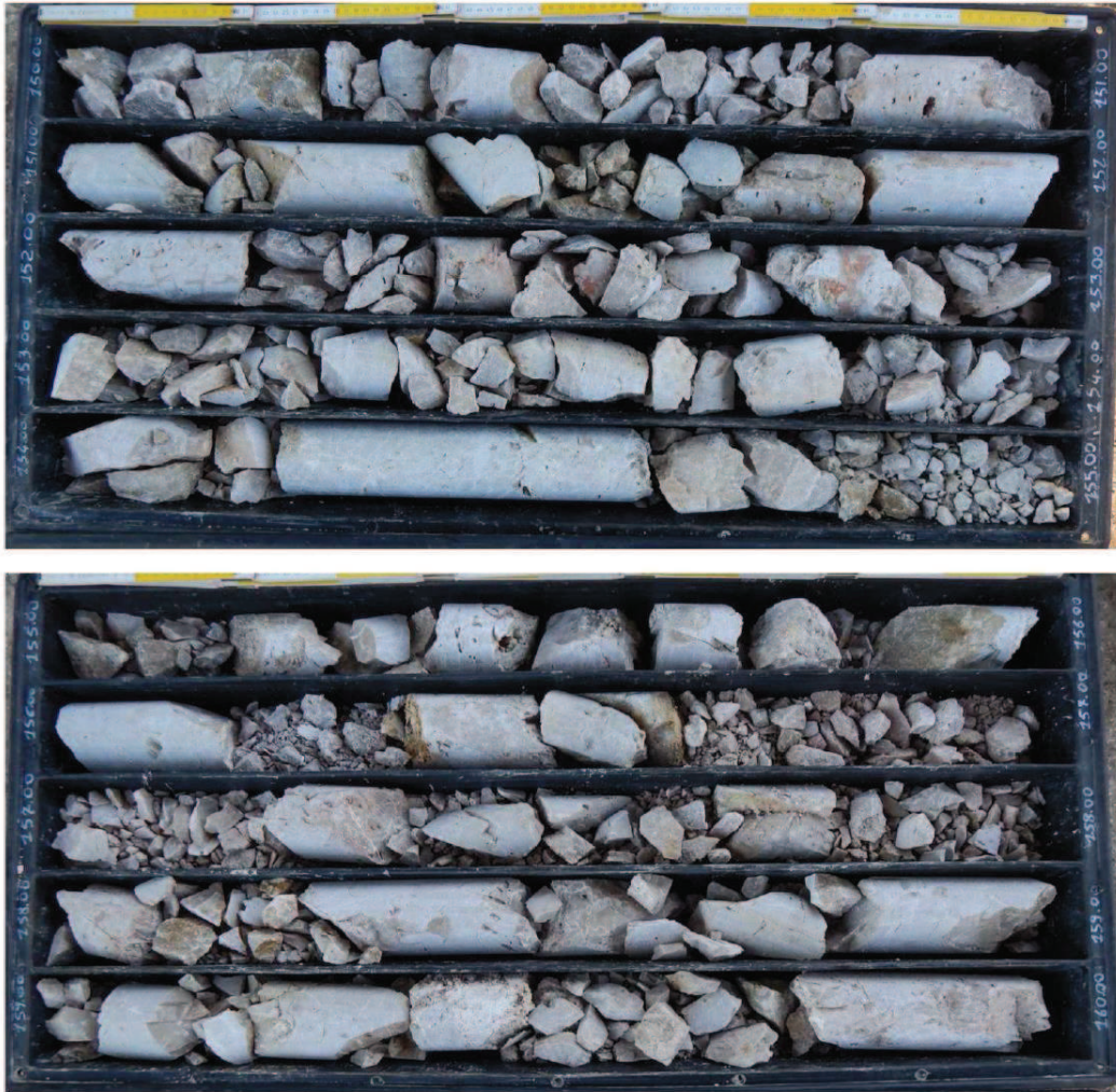
Figura 6.5.b – Foto carote estratte da carotaggio S14D, rappresentative delle condizioni prevalenti per la tipologia di ammasso 3
