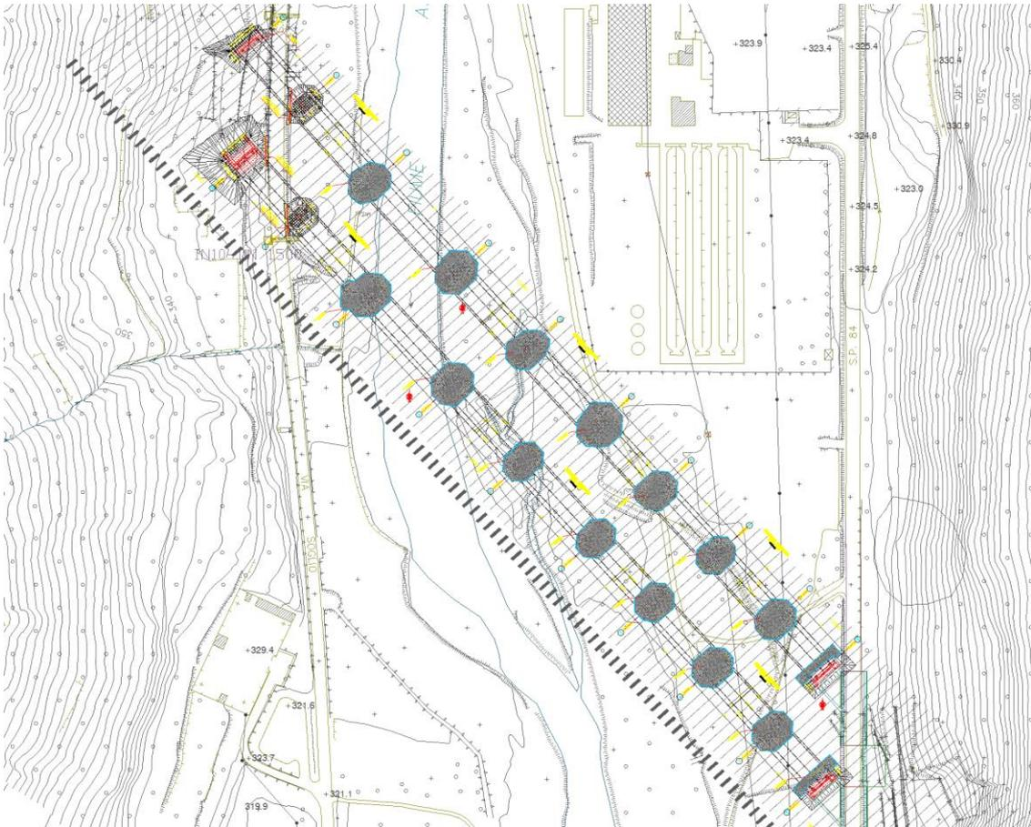
Figura 14 Viadotto Settecà planimetria delle protezioni con massi sciolti
