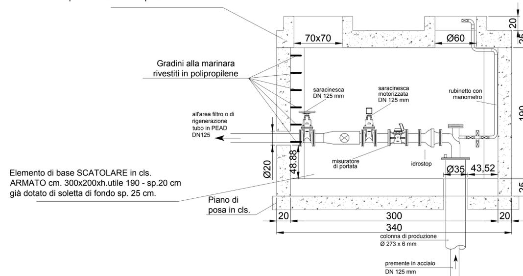
Elemento di base SCATOLARE in cls. ARMATO cm. 300x200xh.utile 190 - sp.20 cm già dotato di soletta di fondo sp. 25 cm.
