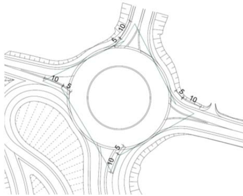
Figura 17 –Schema di verifica visibilità rotatoria di progetto
