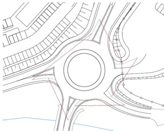
Figura 25 –Schema di verifica visibilità rotatoria di progetto
