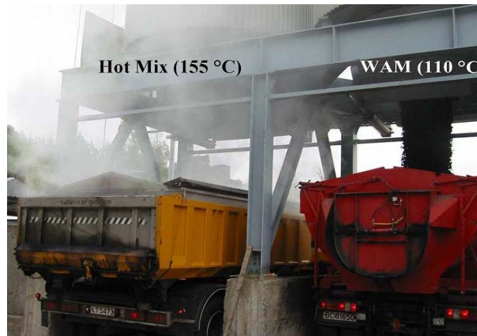
Figura 3: confronto tra conglomerato bituminoso tradizionale e Warm Mix Asphalt in termini di produzione di fumi in impianto
