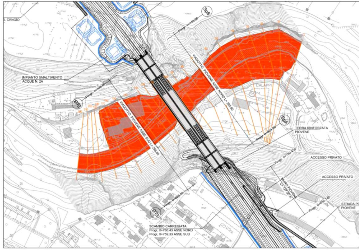
Figura 3 Aree di esondazione del Fiume Astico in corrispondenza del viadotto Piovene – Portata duecentennale – Post Operam
