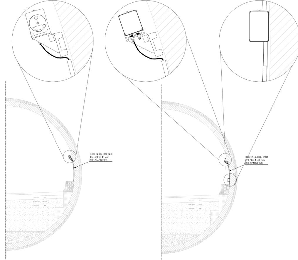
PARTICOLARE INSTALLAZIONE STAZIONE DI MISURA DELLA VELOCITA' E DELLA DIREZIONE DEL VENTO
