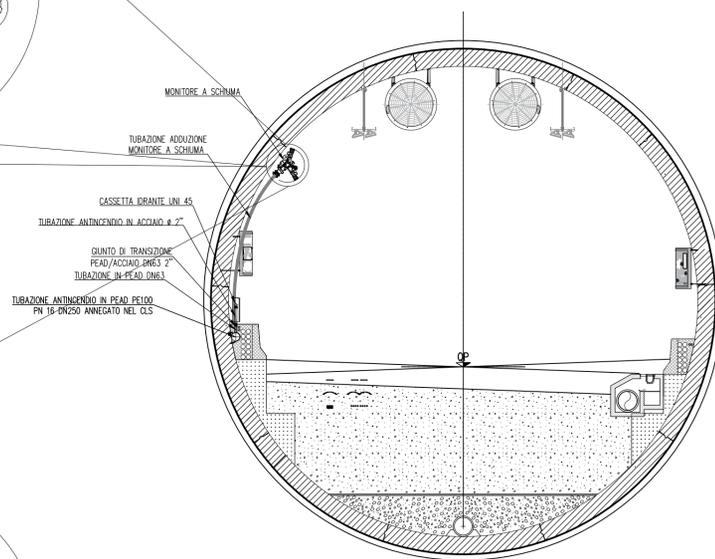
**SEZIONE SCAVO TBM**
