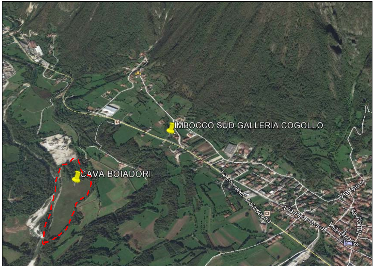
Figura 43 – Cava Bojadori per lo stoccaggio provvisorio delle terre e rocce da scavo e la lavorazione degli inerti
