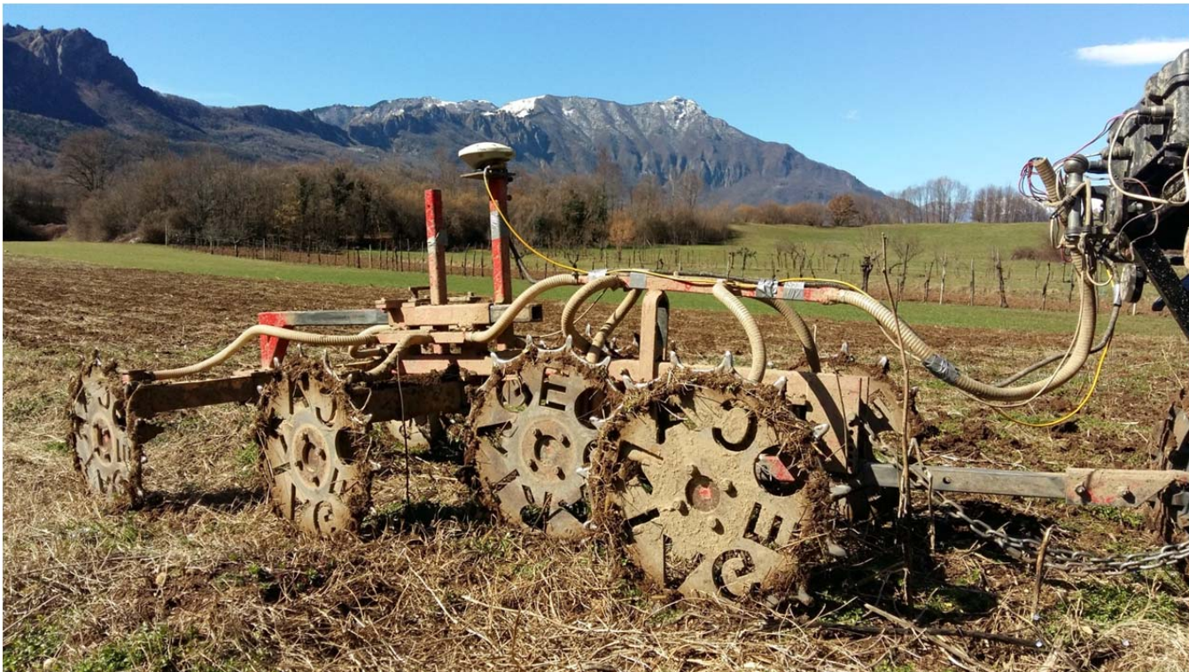
Figura 15 Dettaglio del sistema di acquisizione A.R.P.
