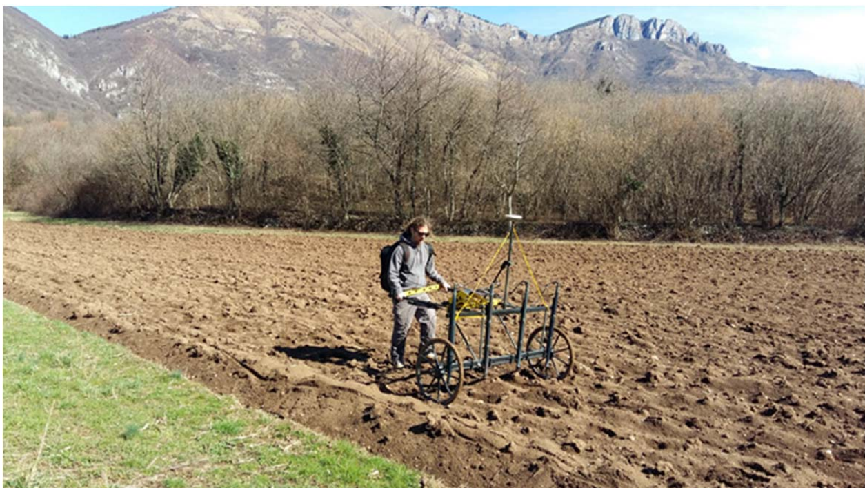
Figura 8- Acquisizione dati gradiometrici su area PrN01
