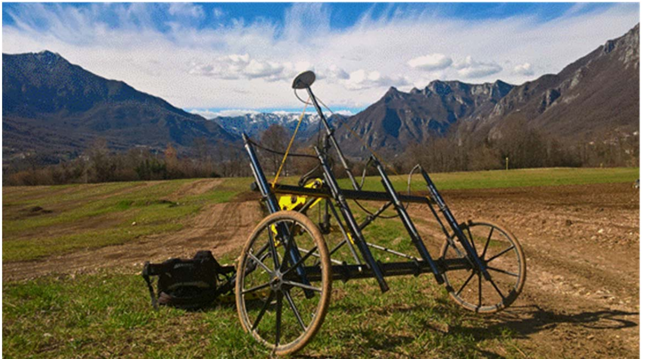
Figura 5- Strumentazione magnetica Fluxgate Foerster interfacciato con GPS centimetrico Trimble
