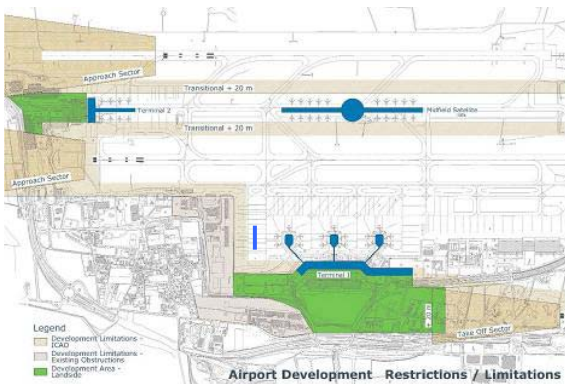
Fig. 11.11 - Schema di sviluppo delle aree terminali e principali zone di vincolo
