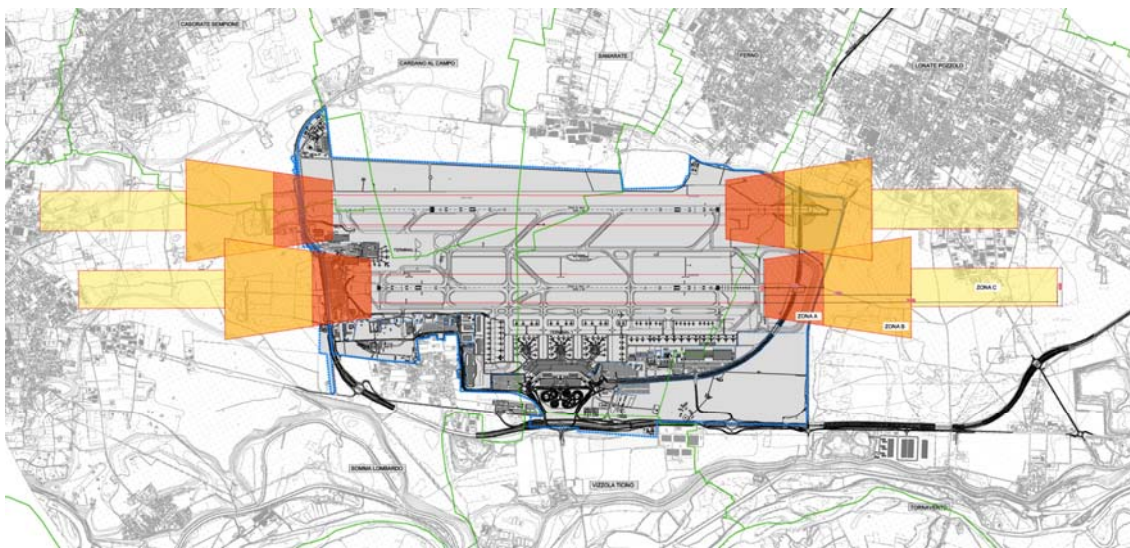
Fig. 4.4 – Zone di tutela in asse pista
