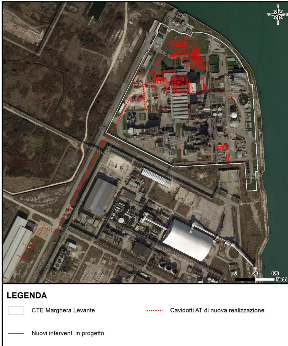
Figura 3.1.1a Vista aerea della Centrale esistente di Marghera Levante con indicazione in rosso delle aree interessate dalle opere in progetto
