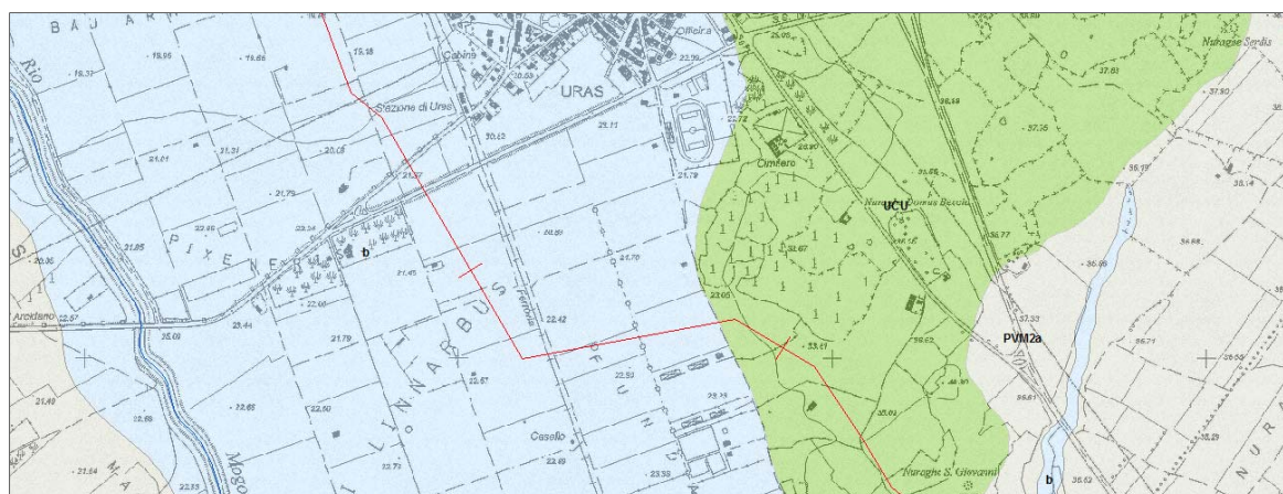
Figura 63. Interazione tracciato/substrato geologico. Settore a sud dell'abitato di Uras. In verde il tratto ricadente nelle vulcaniti basaltiche dell'Unità di Cuccuru Aspru.
