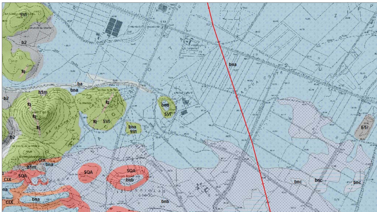
Figura 42. Interazione tracciato/substrato geologico. Settore del sito termale di S'Acqua Cotta.
