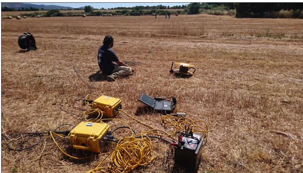
Fig. 32 Sismografi geometrics Geode in fase di acquisizione.
