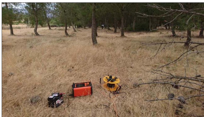
Fig. 31 Georesistivimetro Abem Terrameter LS in fase di acquisizione.
