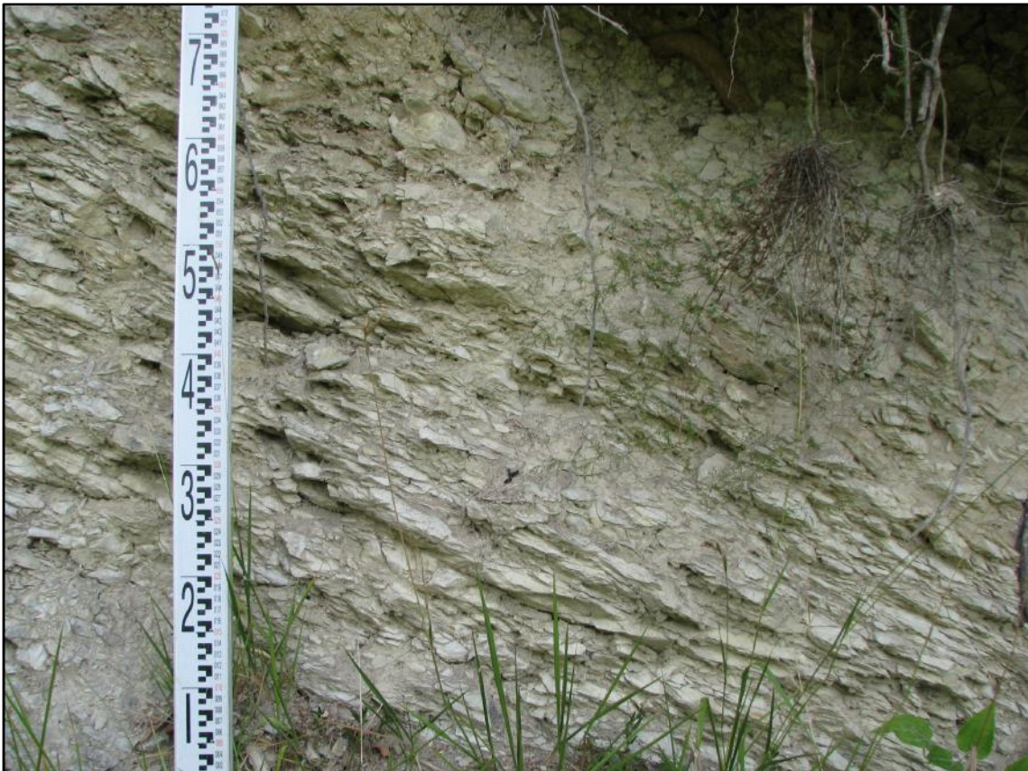
Figura 4.1 Particolare dello Schlier in affioramento sul versante sud di Croce di Calle in cui sono stati eseguiti i rilievi geostrutturali (azimut linea di scansione: N120°E).
