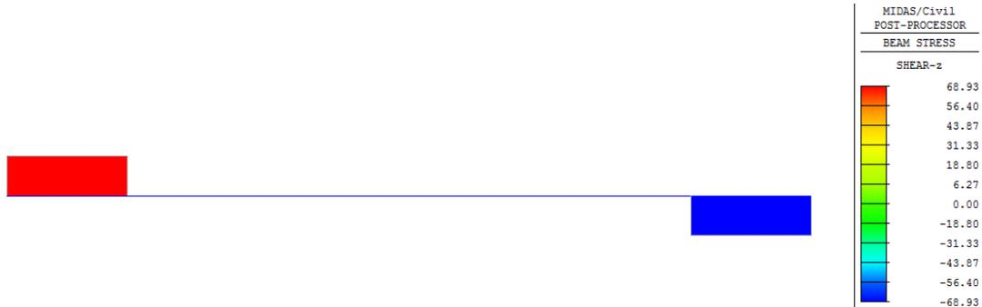
**Figura 58 – Tensioni allo SLU agenti nei traversi di testata in fase di sollevamento**
