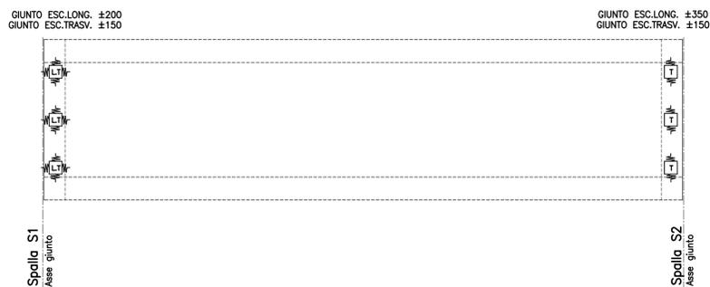
CARATTERISTICHE TECNICHE APPOGGI-ISOLATORI LONGITUDINALI E TRASVERSALI
