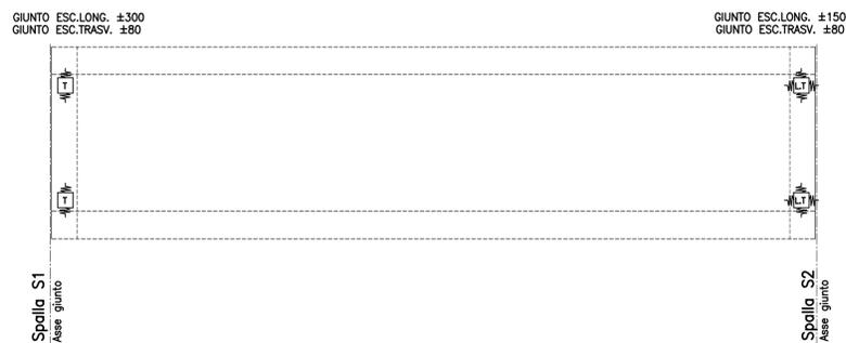
CARATTERISTICHE TECNICHE APPOGGI-ISOLATORI LONGITUDINALI E TRASVERSALI
