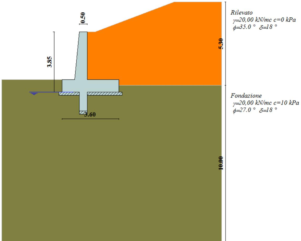
Modello di calcolo muro su PALLI
