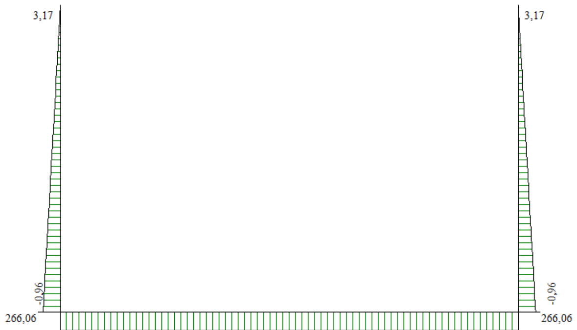
Figura 9 – Involuppo diagrammi dello sforzo normale – SLE
