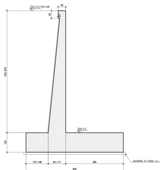
SEZIONE TRASVERSALE D-D scala 1:50
