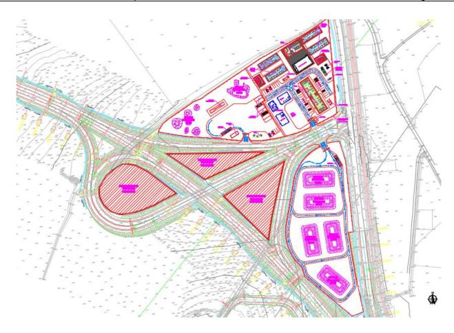
Alla progressiva 0+440 nei pressi dello svincolo di Matelica ovest sono localizzate due aree per <u>impianto di betonaggio e di frantumazione</u> rispettivamente di mq 15.420 e di 18.278 per le lavorazioni delle terre e dello smarino delle gallerie.
