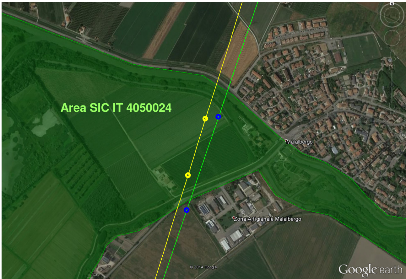
Fig. 5.2: Panoramica aerea dell'area SIC interessata dai lavori. Sono rappresentati: —●— elettrodotto 132 kV n. 702 "Altedo – Ferrara Sud" che sarà demolito; ● sostegni da demolire —●— elettrodotto 220 kV n.226 "Colunga – Palo 130" che sarà declassato a 132 kV; ● sostegni che vengono conservati — con il poligono verde l'area SIC in questione.
