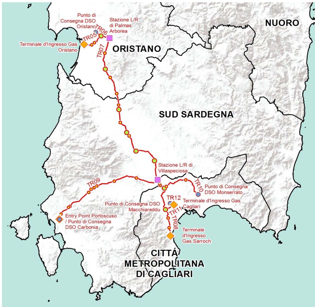
**Figura 3.A: Sistema Trasporto Gas naturale della Sardegna – Sezione Centro-Sud**
