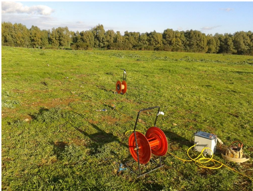
Figura 2.1: Strumentazione Prospezione elettrica tomografica (Profilo 3)
