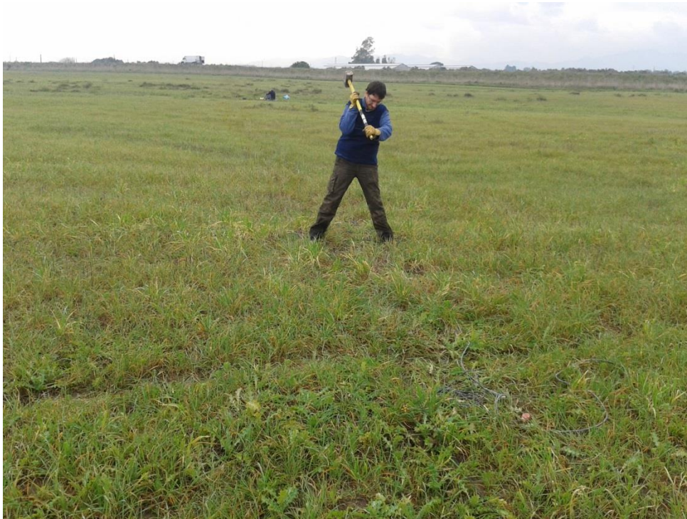
Figura 3.3: Esempio Energizzazione sismica (profilo P4)
