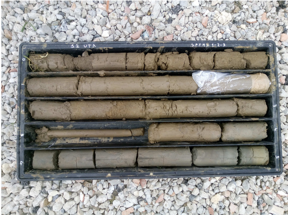
SONDAGGIO 2 da 0,00 m a 5,00 m
