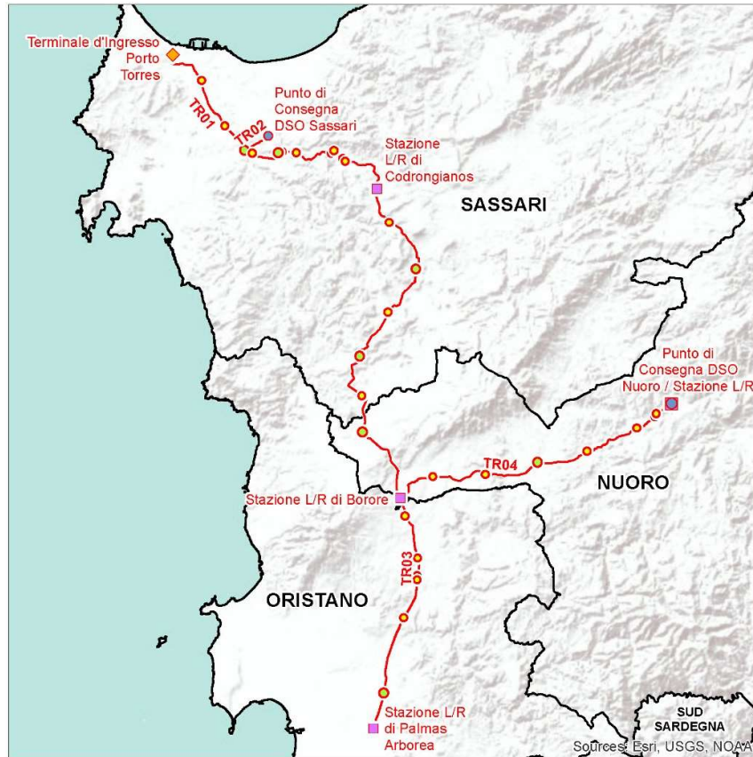
Figura 3.A: Sistema Trasporto Gas Naturale della Sardegna (Sezione Centro-Nord)
