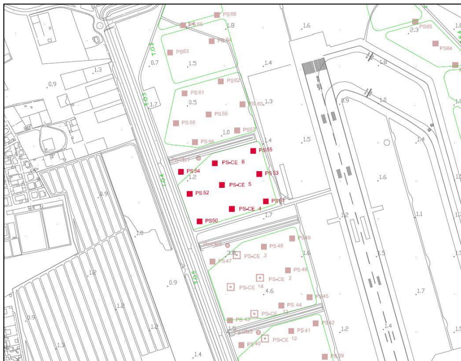
Figura 4-2 Stralcio planimetrico con l'ubicazione dei punti di indagine nelle aree di riutilizzo per il rimodellamento del terrapieno T.O.4
