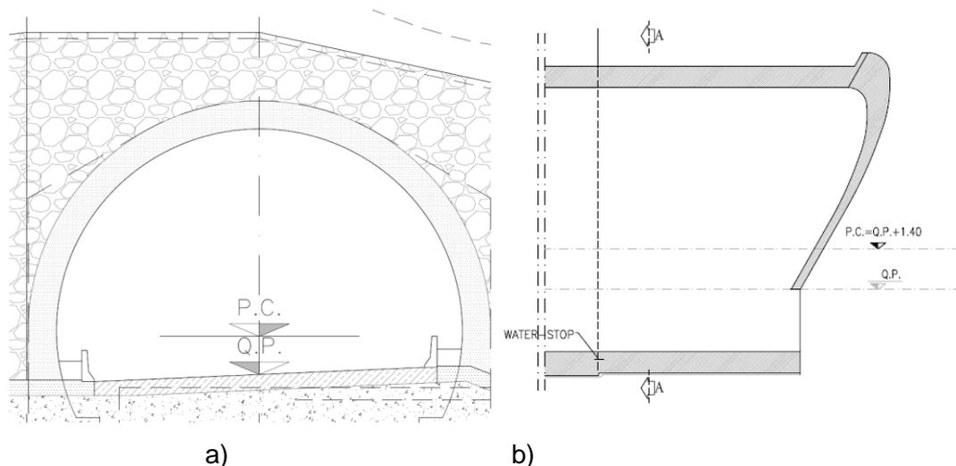
**Figura 3 imbocco Est con portale verticale (a), imbocco Ovest a becco di flauto rovesciato (b)**
