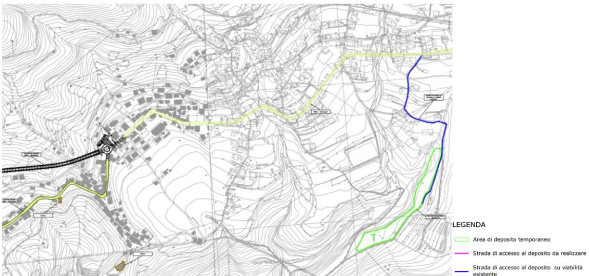
**Figura 8 localizzazione dei depositi di stoccaggio dei materiali di scavo**
