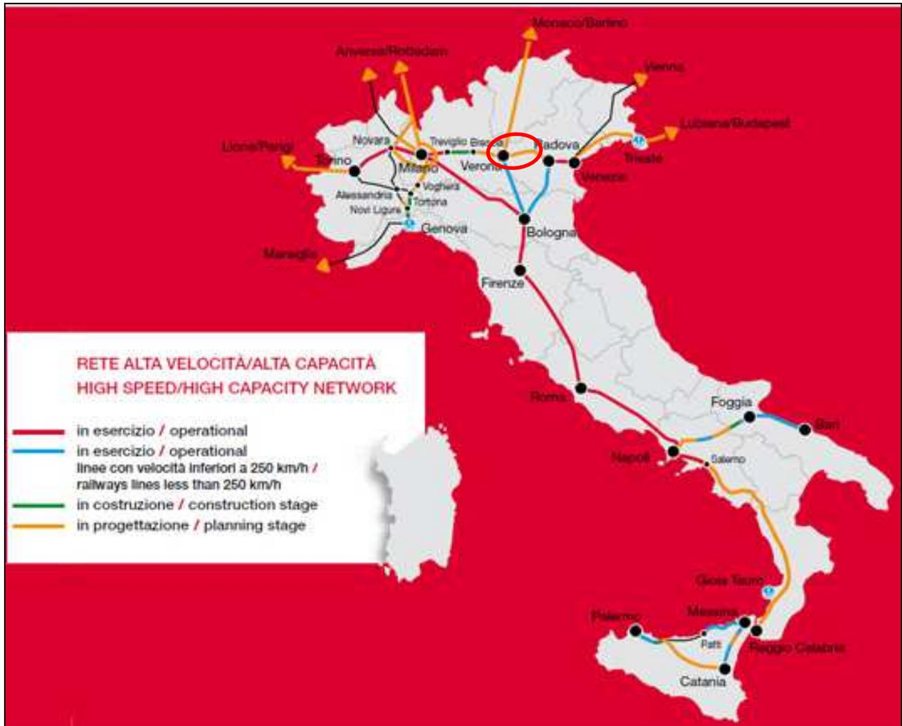
Figura 6-4 – Fasi di progettazione della rete ad alta velocità e ad alta capacità in Italia.
