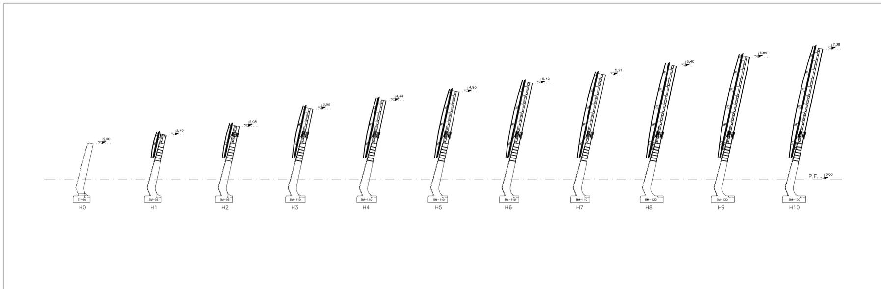
Fig. 1 - Tipologici di barriera da H0 a H10 (nota: la serie standard prevede la barriera con aggetto per aumentare l'efficacia acustica)
