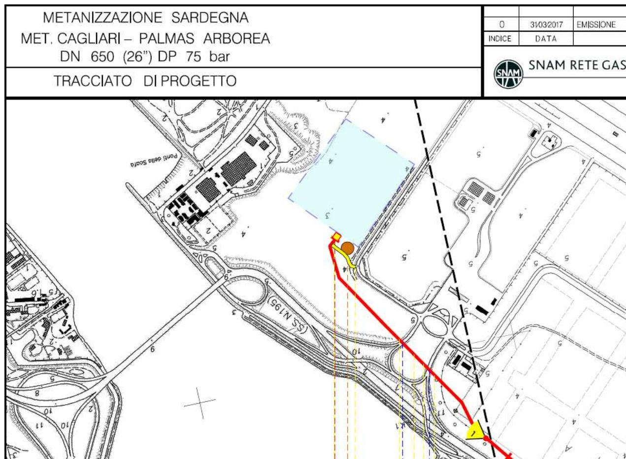
Figura 2 – Stralcio planimetrico riportante l'ubicazione del 1° punto di intercettazione di derivazione importante del metanodotto SNAM (modificato). Per una maggiore comprensione in questa immagine è stata inserita l'area di ubicazione dell'impianto Terminal GNL (vedasi [Allegato 2](#)).
