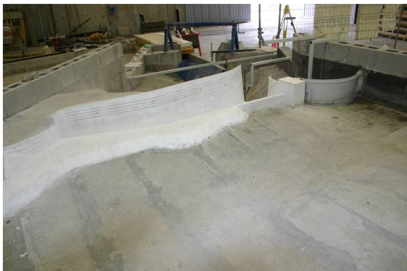
Figura 7 – Vista dall'invaso di monte delle opere di scarico superficiale in Configurazione III
