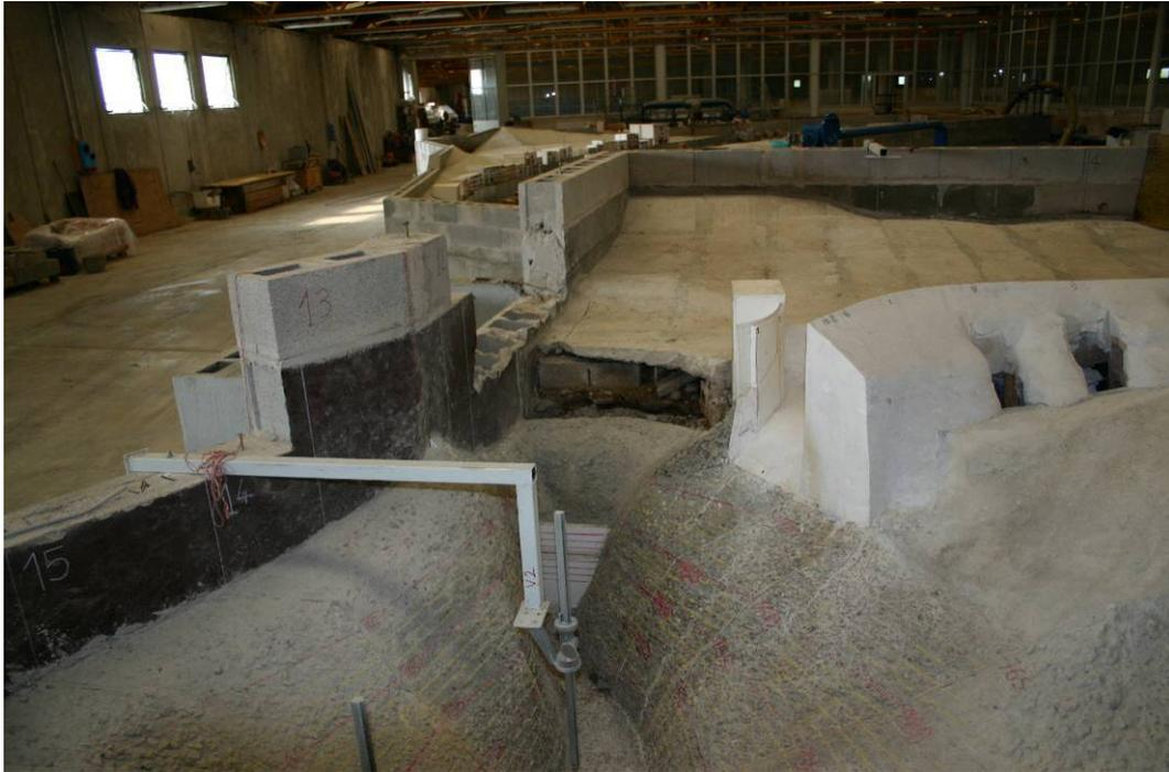
Figura 16 - Demolizioni sul precedente modello
