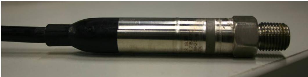
Figura 33 - Il sensore di pressione GE DRUCK PDCR 1830.
