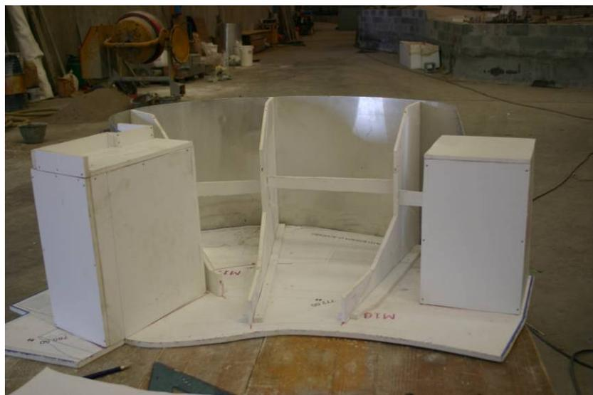
Figura 24 - Modine per il versante destro. Si vedono anche le due opere di presa riprodotte con lastre di PVC
