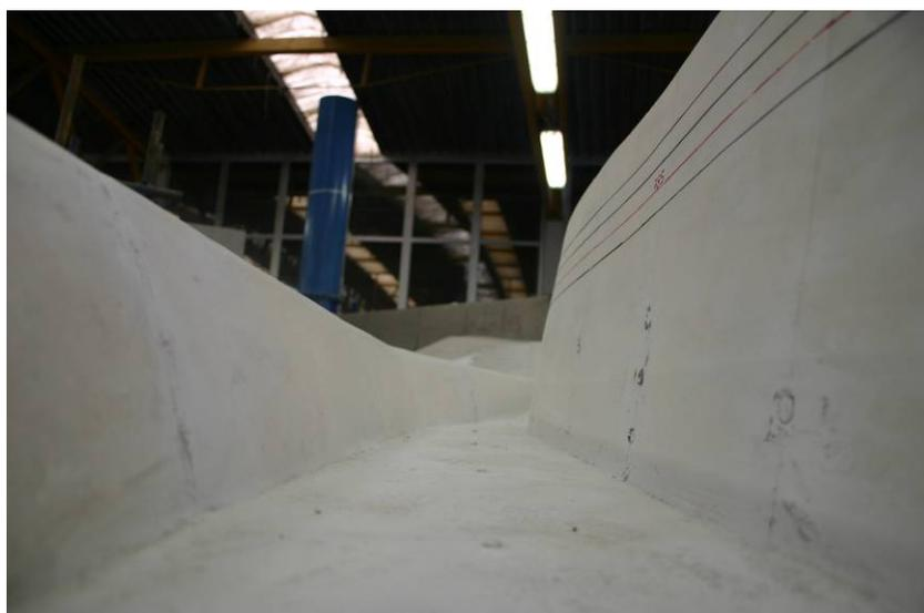
Figura 9 – Particolare del canale di scarico in Configurazione III: sulla sinistra lo sfioratore, sulla destra il muro innalzato con le linee di quota tracciate.
