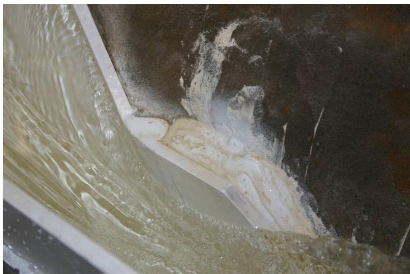
Figura 48 - Pelo libero sulla parte di valle del muro di sinistra
