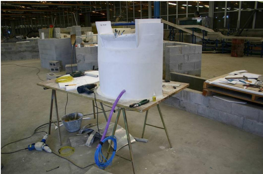
Figura 21 - Diga in fase di ultimazione. Si vedono: il getto di finitura quasi completato, il tubo corrugato e le prese di pressione inserite
