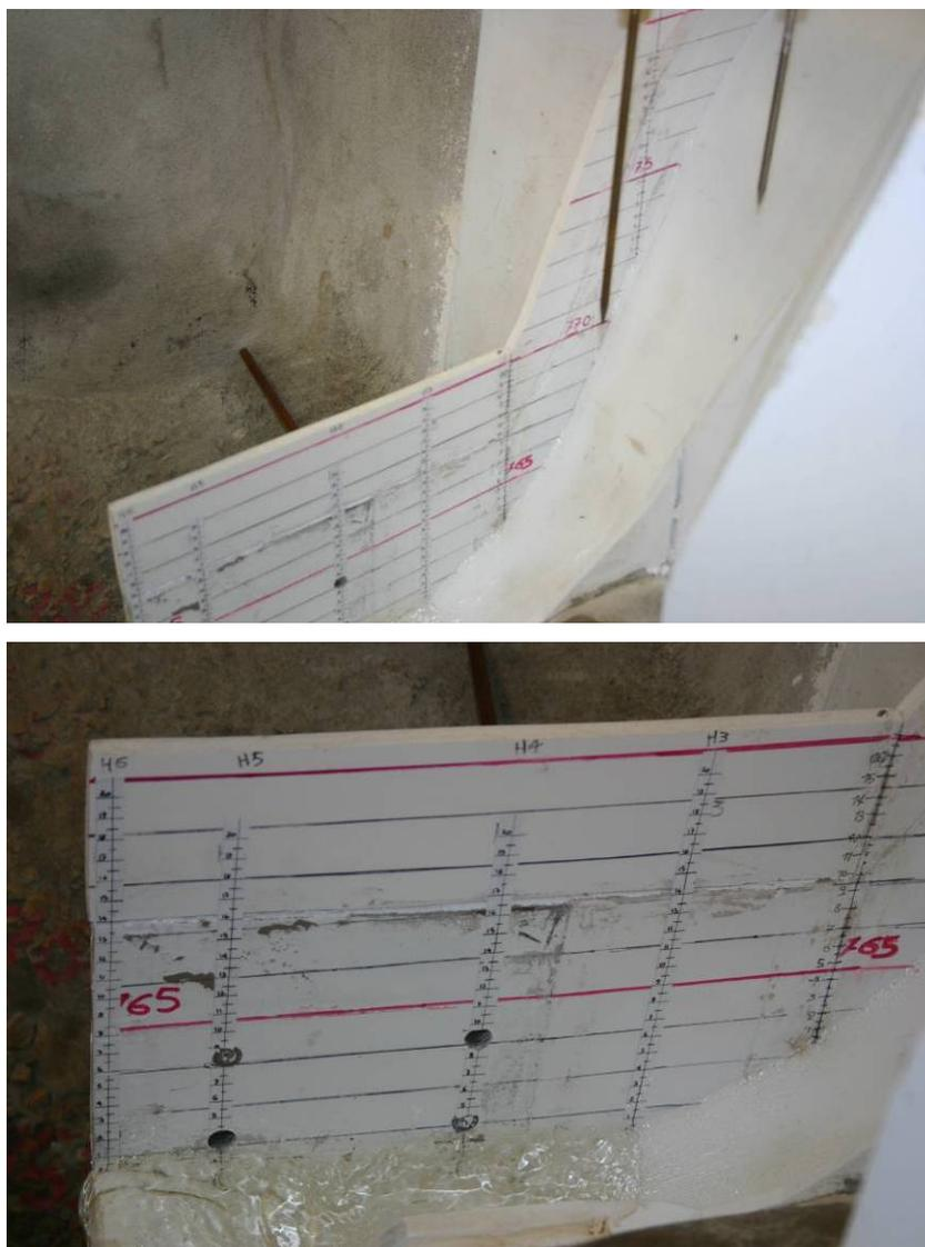
Figura 72 - Rilievo fotografico del pelo libero sul muro di destra
