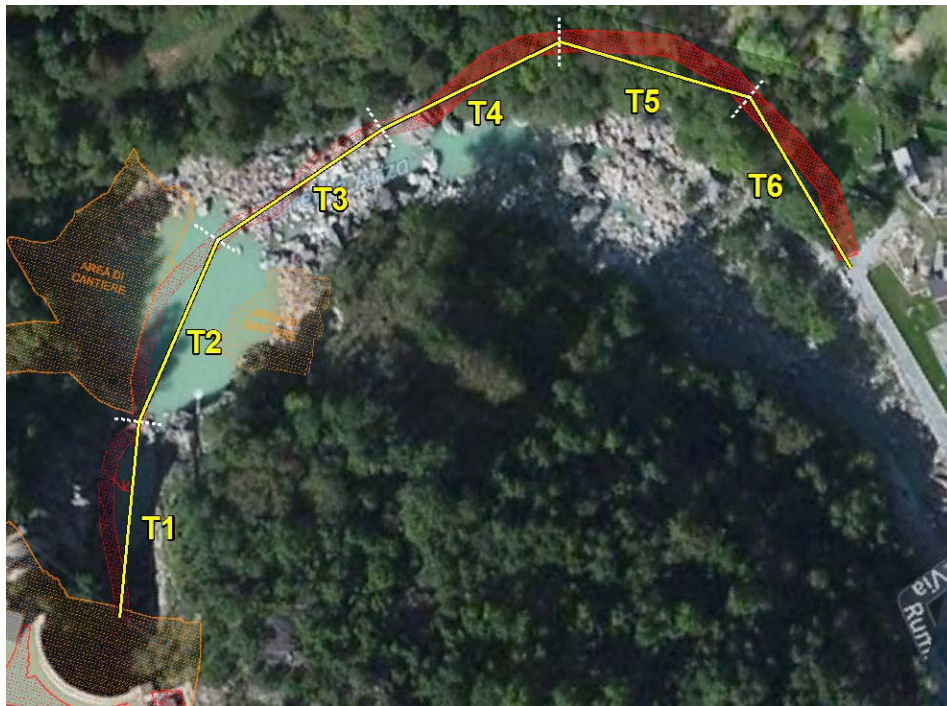
Figura 4.3.1.2a Discretizzazione pista di cantiere V1 per trasporto verso l'esterno del materiale demolito
