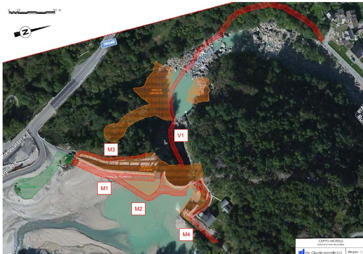
L'area di cantiere da adibire all'installazione di uffici e apprestamenti dell'Appaltatore (indicata in verde in figura) potrà essere realizzata in corrispondenza del piazzale sterrato ubicato sulla sponda sinistra del serbatoio, appena a monte dello scarico di superficie esistente.
