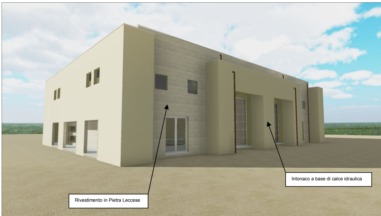
Fig. 5: Locale Caldaie – Vista Nord-Est
