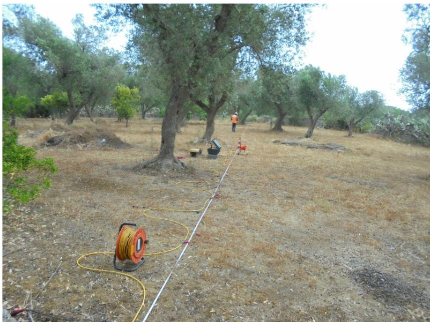
Foto 3 - Melendugno. TAP. Prospezione geoelettrica. Profilo **PR03**.
