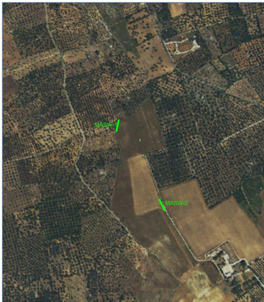
*Figura 16 – Melendugno. TAP. Prospezioni sismiche MASW eseguite nell'area PRT.*
