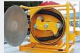
Schlauchpumpe HP-50 mit geöffnetem Pumpendeckel
