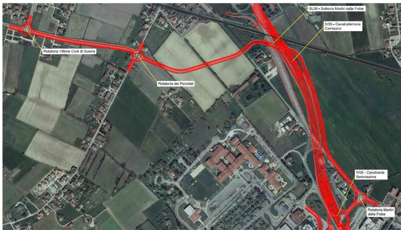
Fig. 10.9 – Prolungamento di Via Martiri delle Foibe
