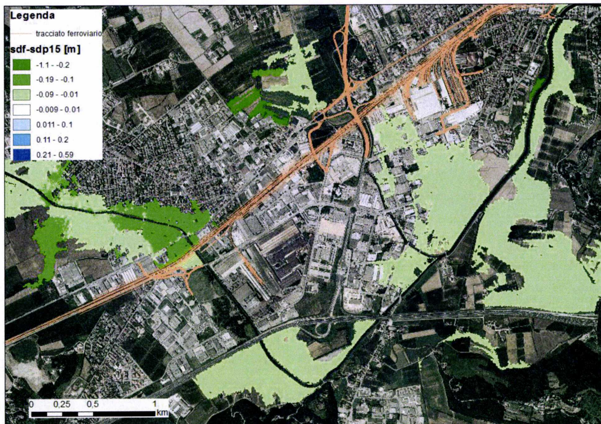
Figura 2-9: risultati delle simulazioni Tr300 per lo stato di progetto 15: in scala di verde le zone già allagate nello stato di fatto ma con altezze idriche minori nello stato di progetto in esame (miglioramento dello stato di fatto); in scala di azzurro le zone allagate nello stato di progetto con altezze idriche maggiori rispetto allo stato di fatto (peggioramento dello stato di fatto)
