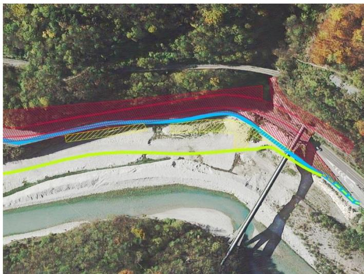
Con specifico riferimento a queste ultime opere, per permetterne la realizzazione senza limitare il doppio senso di marcia sulla SS n.51, si prevede la realizzazione di alcune deviazioni puntuali, tali appunto da permettere per tutta l’esecuzione dell’opera il doppio senso di marcia sulla statale e, parallelamente, dare spazio ad aree di cantierizzazione per l’esecuzione delle opere d’arte e la sosta e manovra dei mezzi d’opera.
