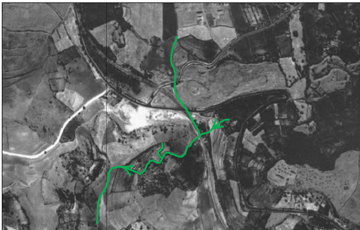
Foto 6 – Ortofoto dello Svincolo di Bonorva risalente al 1954, che mostra (in verde) l'andamento del reticolo idrografico precedentemente alla costruzione delle opere.
