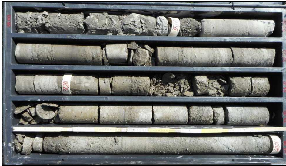
Foto 1 – Formazione di Mores in Facies siltitica incontrata nel sondaggio S11 di Sondedile s.r.l. (anno 2015) in corrispondenza dello Svincolo di Bonorva nord.
