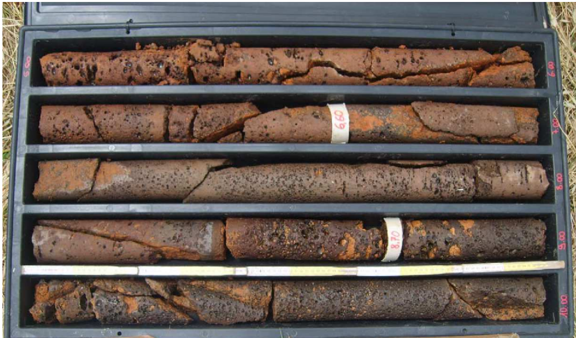
Foto 3 – Basalti di Campeda incontrati nel sondaggio S6pz di Sonedile s.r.l. (anno 2015) In corrispondenza dello Svincolo di Bonorva sud.
