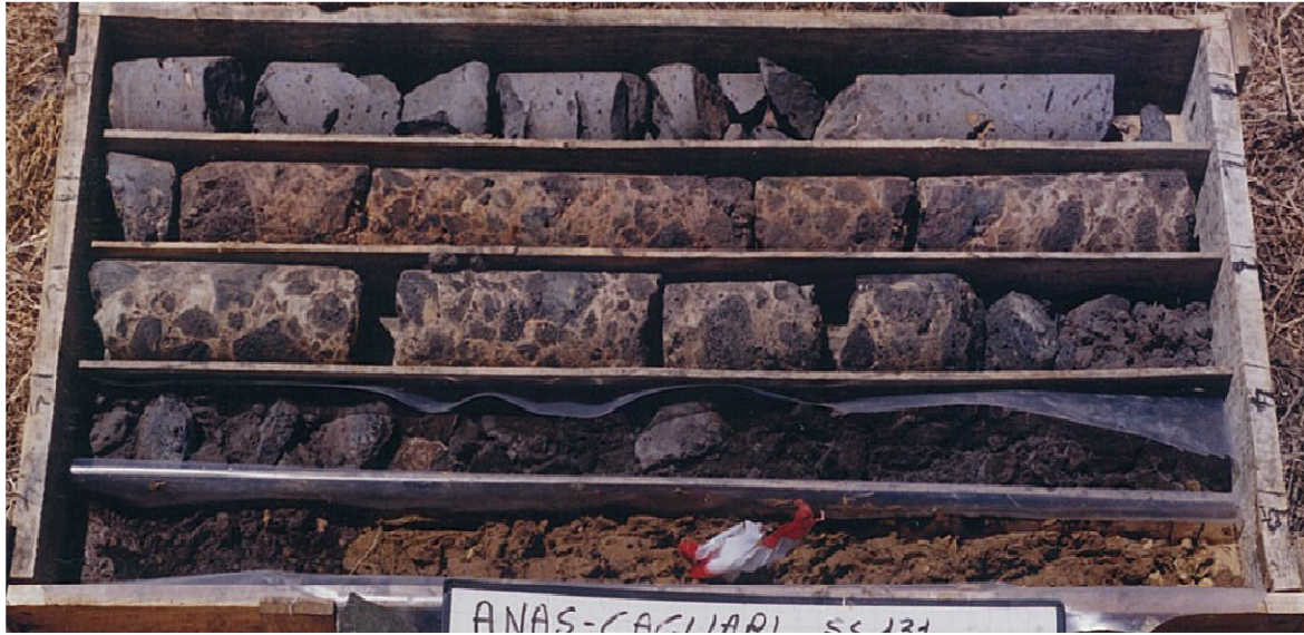
Foto 4 – Basalti del Logudoro incontrati nel sondaggio S34 di Micropali s.a.s. (anno 1998) nella parte alta dello Svincolo di Bonorva nord.
