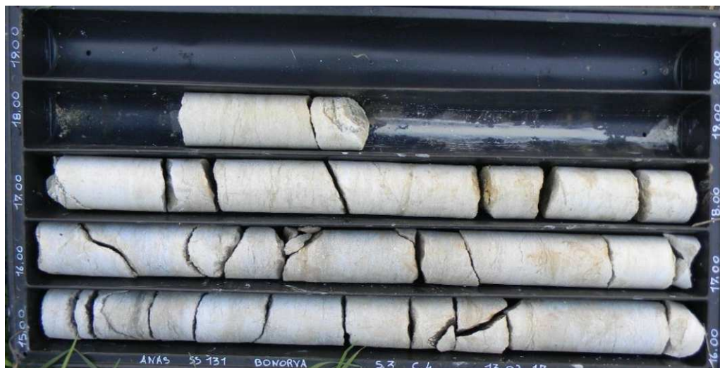
Foto 2 – Formazione di Mores in Facies calcarenitica incontrata nel sondaggio S3 di Angius (anno 2017) in corrispondenza dello Svincolo di Bonorva nord.
