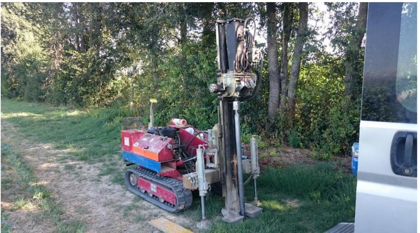
Piazzamento sonda Geoprobe in corrispondenza del sostegno 42G
