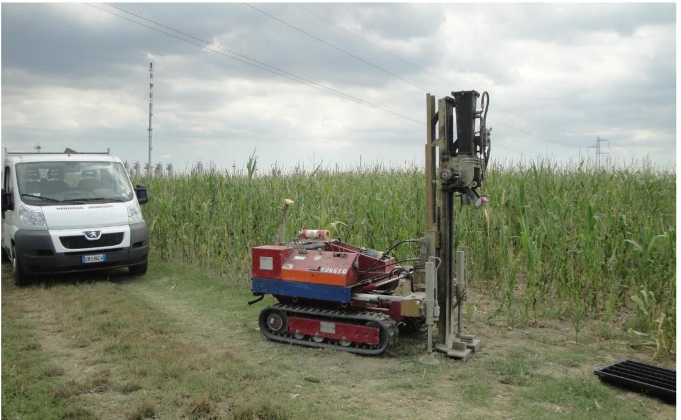
Piazzamento sonda Geoprobe in corrispondenza del sostegno 42D
