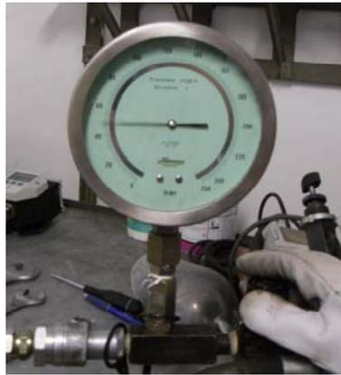
**Figura 5.4** - Pressione applicata dalla pompa oleodinamica durante la prova CLS-A.
