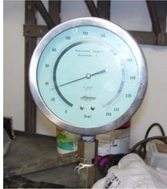
**Figura 5.6** - Pressione applicata dalla pompa oleodinamica durante la prova CLS- B.
