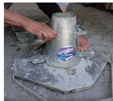
Il cono viene sollevato e l'abbassamento allo slump misurato
