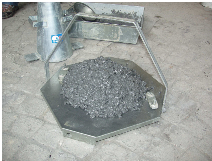
AGS + 2% bentonite in 3 l di acqua. Slump 19
