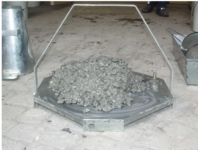
CLS + 2% bentonite in 3 l d'acqua. Slump 17
