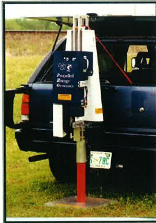
**Figura 2-8: esempio di sistema “Weight Drop”**
