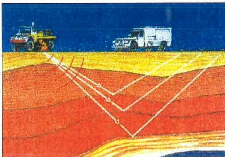
**Figura 2-2: rilievo a vibratorio**
