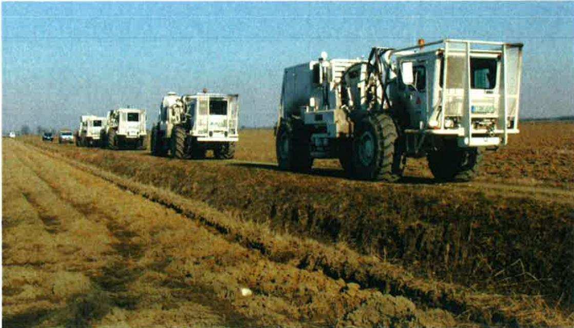
**Figura 2-6: array di vibroseis in linea**
