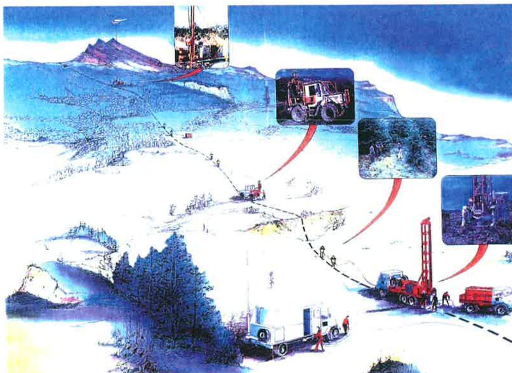
**Figura 2-9: rappresentazione-tipo delle operazioni di campagna di un rilievo sismico 2D**
