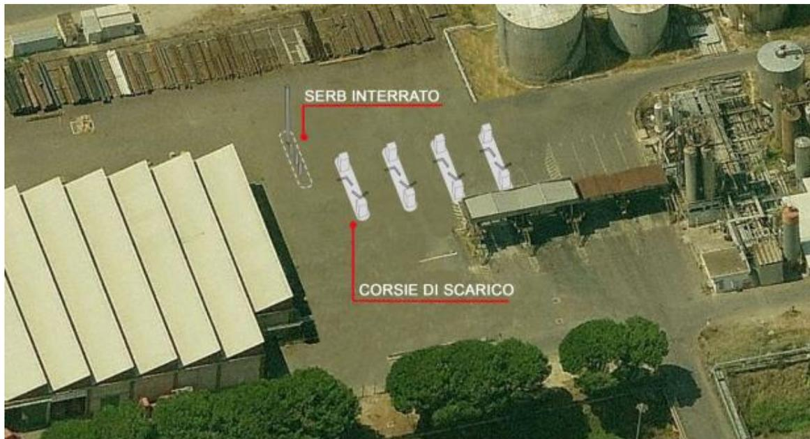
Lo scarico avverrà per gravità mediante otto linee singole che confluiranno in un collettore unitario inclinato afferente ad un unico **serbatoio interrato a doppia parete** (Crude Oil Unloading Drum).
