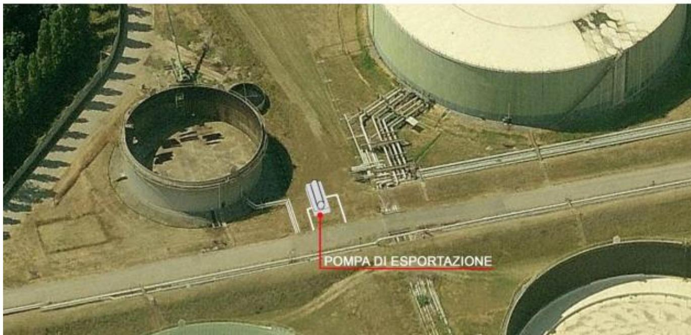
Per l'invio del greggio all'asportazione via nave attraverso l'oleodotto esistente da 16" sarà installata una **nuova pompa centrifuga orizzontale** di portata di progetto di 728 m<sup>3</sup>/h, dotata di un sistema di tracciatura LPS.
