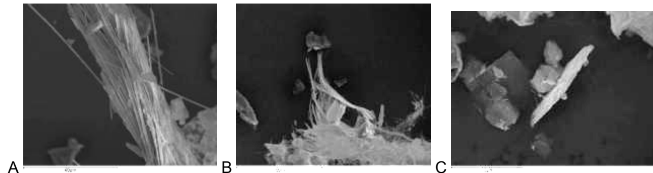
Figura 9-10. Osservazione in microscopia elettronica a scansione della componente fibrosa dei minerali presenti nel suolo agricolo selezionato per lo studio. Sulla base delle analisi EDS sono stati riconosciuti: crisotilo (A, B) e smectite (C)
