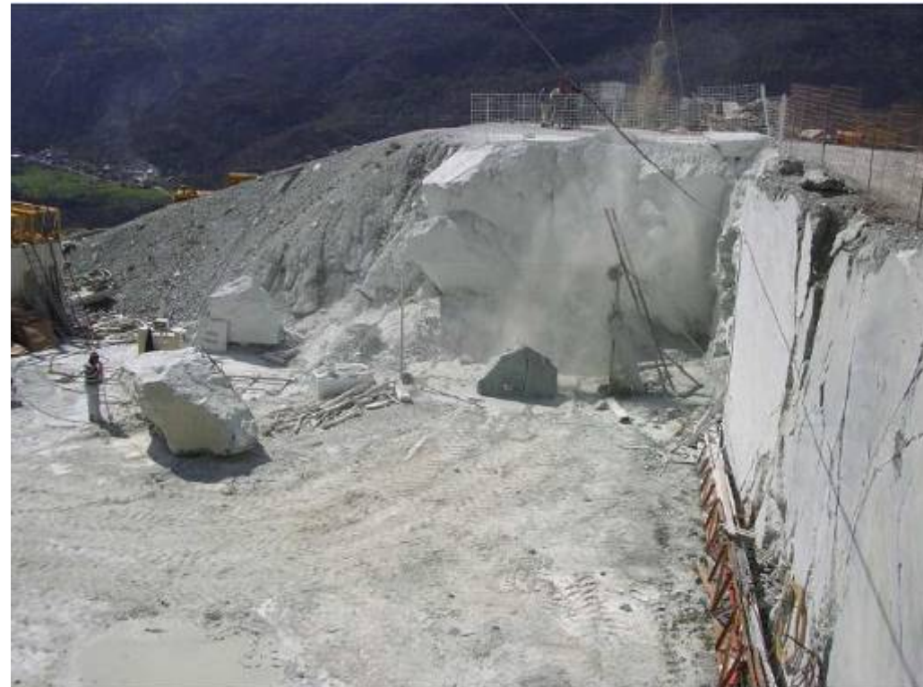
Figura 9-4 – Taglio di un grosso blocco di pietra con l'ausilio del filo diamantato (cava di marmo verde)
