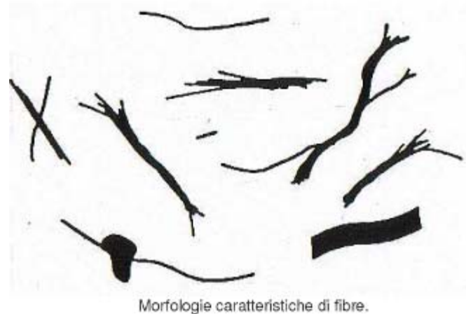
Figura 9-5 Morfologie caratteristiche delle fibre di amianto
