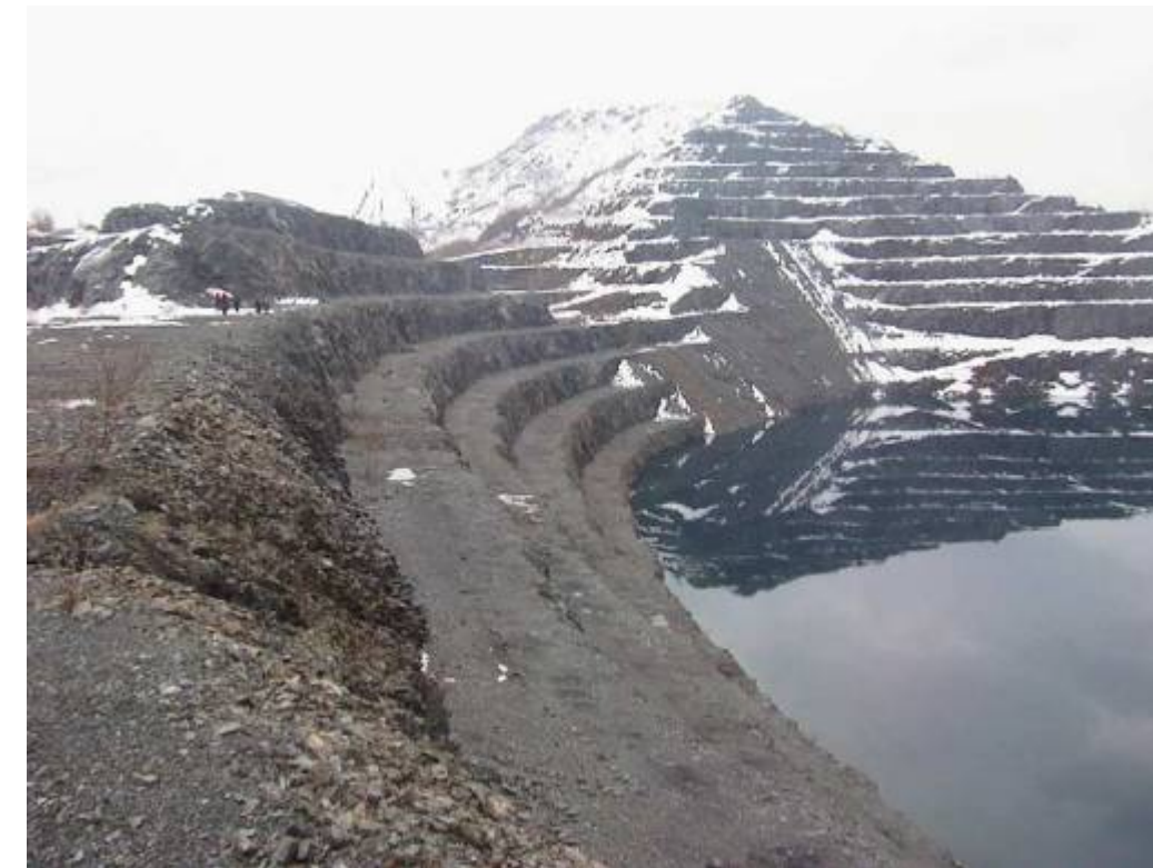
Figura 9-3 - Miniera di amianto di Balangero - Visione dell'area di estrazione con i caratteristici gradoni e il lago artificiale di 12 ettari
